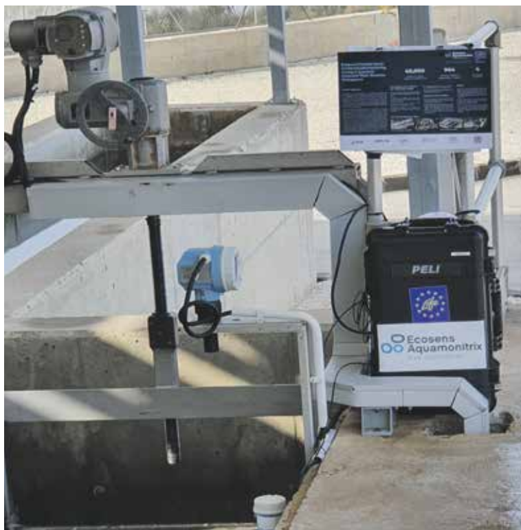
Imagen de uno de los dispositivos de bajo coste, por los que se conoce en tiempo real la calidad de las aguas.
