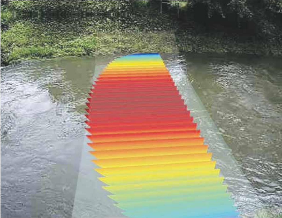
Ejemplo de procesamiento de videos para la obtención de caudales. ‘SmartLagoon’ combinará tecnologías de sensorización de bajo coste como por ejemplo la videomonitorización no intrusiva en ramblas, los datos obtenidos mediante ciencia ciudadana y las técnicas de teledetección.
