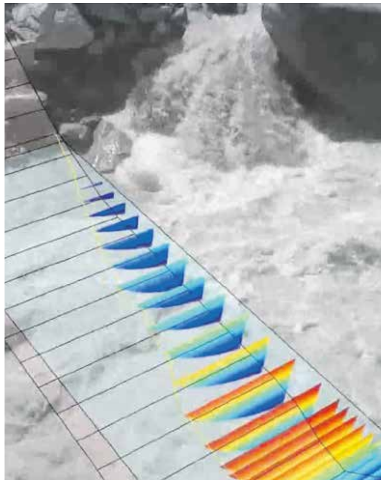
Medición de la velocidad del flujo a través de técnicas de velocimetría de imagen de partícula.
